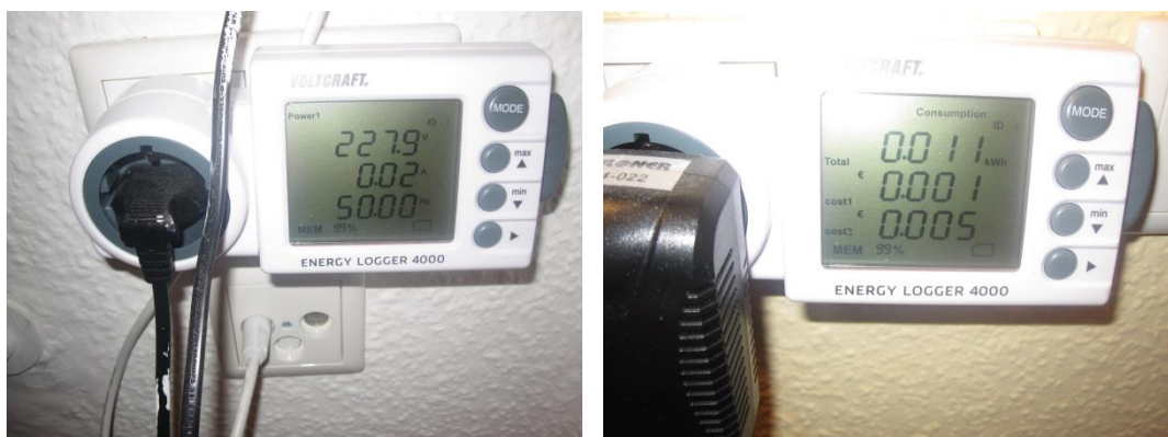
Abbildung 15: Standby Verbrauch an einem Fernsehgerät und Schreibtischlampe
